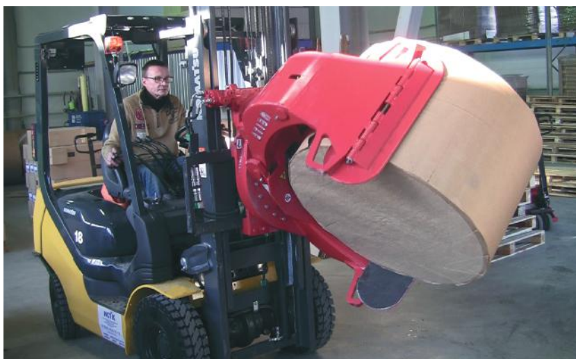
Новый погрузчик с устройством поворота рулона, позволяющим разгружать и складировать материнские рулоны из любых положений
