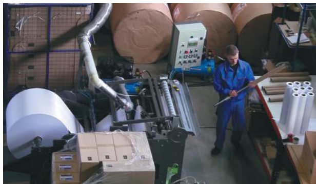
Процесс перематки и упаковки готовой продукции
